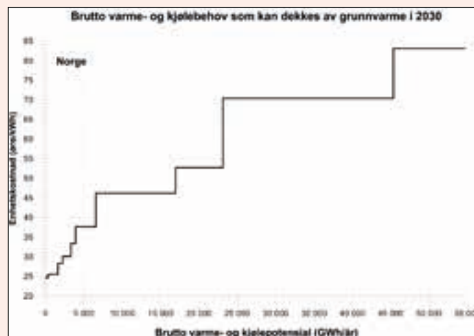
Enhetskostnader for brutto varme- og kjølebehov som kan dekkes av grunnvarme i 2030 i Norge for ulike sett med løsningsalternativer for grunnvarmeanlegg og geologi.
